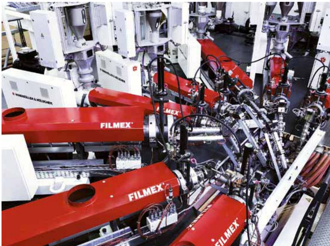
Filmex-Extruder, die Kunststoffschmelze erzeugen, aus der in einem späteren Arbeitsgang Flachfolie entsteht – Hersteller der Extruder ist ein Unternehmen aus NRW: die Windmüller und Hölcher KG aus Lengerich.
